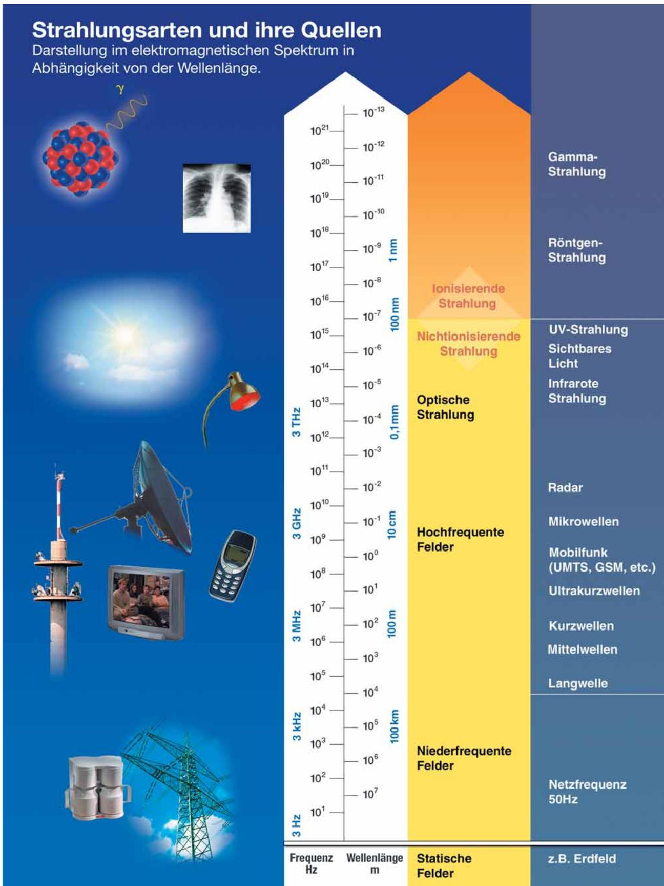
Abb. 3.1: Das elektromagnetische Spektrum
