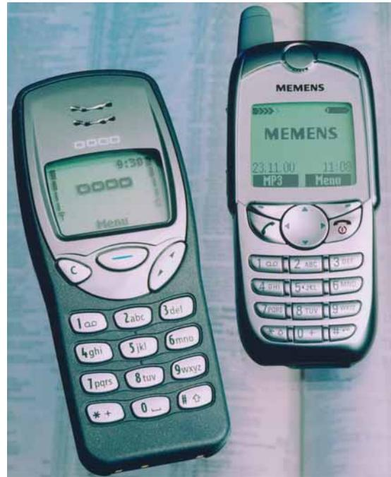
Handy mit sichtbarer und unsichtbarer Antenne
