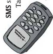
Mein **Handy** wandelt die SMS in ein unsichtbares, lautloses und nicht fühlbares Funksignal um. Das Funksignal wird über die Handyantenne an eine Antenne der nächsten Mobilfunkstation gesendet. Erhalte ich eine SMS, wandelt mein Handy das ankommende Funksignal wieder in einen Text um.
