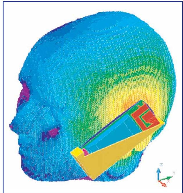
SAR-Werte an der Oberfläche eines Modellkopfes während eines Handytelefonats.
