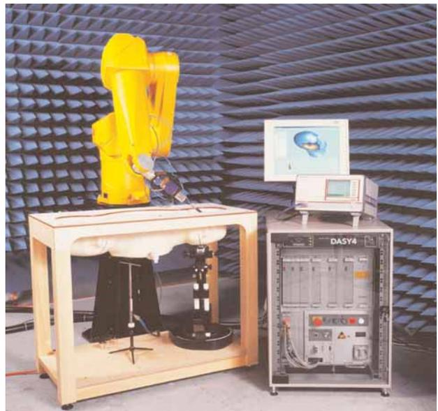
Abb. 6.1: Bestimmung von SAR-Werten an genormten Phantomköpfen unter standardisierten Bedingungen (IT'IS Foundation, 2006)
