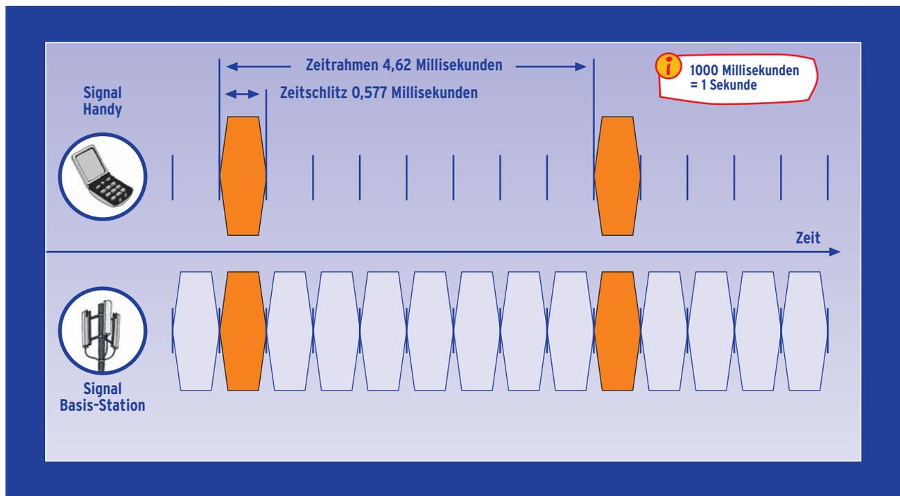
Abb. 3.3: Schematische Darstellung der Signalform bei Handy und Basisstation (Mobilfunkstation) im D- und E-Netz, GSM-Standard (verändert nach [www.bmwi.de/Navigation/Wirtschaft/Telekommunikation-und-Post/Mobilfunk/technik,did=36600.html](http://www.bmwi.de/Navigation/Wirtschaft/Telekommunikation-und-Post/Mobilfunk/technik,did=36600.html))
